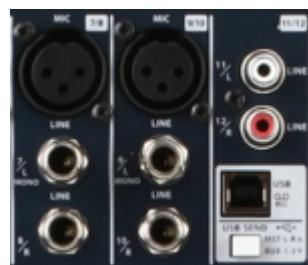
Sur ce type d'entrée on peut brancher un micro en XLR et un autre via la prise JACK (on sera en mono). Si on plugge les 2 prises JACK on passe en stéréo.
