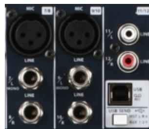
Sur ce type d'entrée on peut brancher un micro en XLR et un autre via la prise JACK. Si on plugge les 2 prises JACK on passe en stéréo (?). Par contre le volume est commun. Si des micros batterie sont branchés dessus, on peut par exemple, reculer le micro de la grosse caisse pour atténuer le volume.
