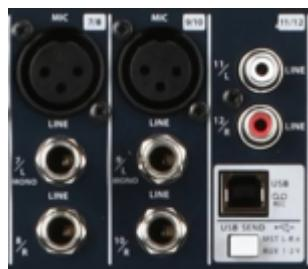
Sur ce type d'entrée on peut plugger un micro en XLR et un autre via la prise JACK. Je en sais pas si on peut plugger le XLR + les 2 prises JACK. Quoiqu'il en soit le volume est commun. Si des micros batterie sont branchés dessus, on peut par exemple, reculer le micro de la grosse caisse pour atténuer le volume si on veut pas baisser l'autre micro ...
