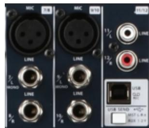
Sur ce type d'entrée on peut brancher un micro en XLR et un autre via la prise JACK. Je ne sais pas si on peut brancher le XLR + les 2 prises JACK. Quoiqu'il en soit le volume est commun. Si des micros batterie sont branchés dessus, on peut par exemple, réduire le micro de la grosse caisse pour atténuer le volume si on veut pas baisser l'autre micro ...
